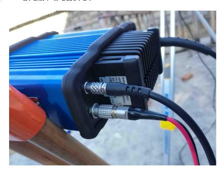
**DG-3** 线另外一口接主机,V90 扒开 com 橡胶盖下,有 com 口,也是红点对红点,插进去。
