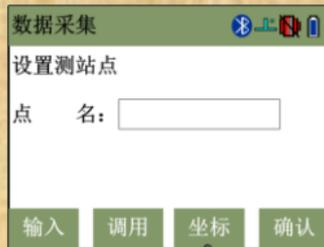
①按【F3】键[坐标]，输入站点坐标后确认返回，再按【F3】键[记录]即完成站点设置。
