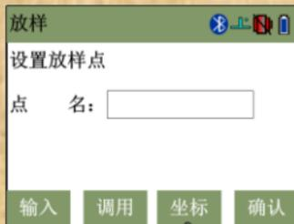
①按【MENU】键→“放样测量”设置工作文件→“设置放样点”，进入点放样界面。
