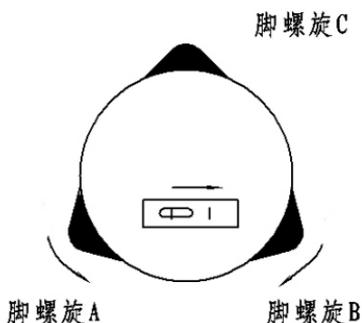
②将仪器绕竖轴旋转 $90^{\circ}$ ，再旋转另一个脚螺旋C，使管水准器气泡居中。
