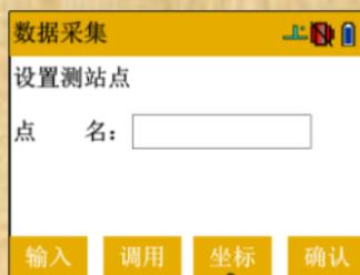
①按【F3】键[坐标]，输入完站点坐标后确认返回，再按【F3】键[记录]即完成站点设置。
